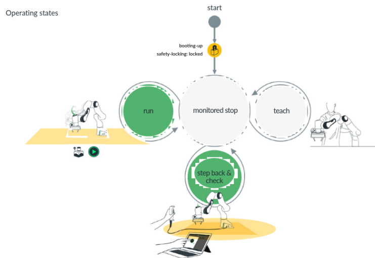
FIGURE II.1.32 – Fonctionnement du mode apprentissage pour le bras robotique Panda. Source : FRANKA EMIKA ROBOT'S INSTRUCTION HANDBOOK
