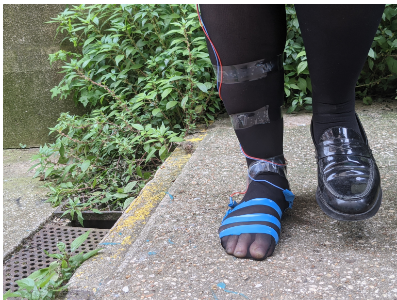
FIGURE II.1.6 – détail de la performance- poser son pied par terre modifie la valeur de la tension du velostat
