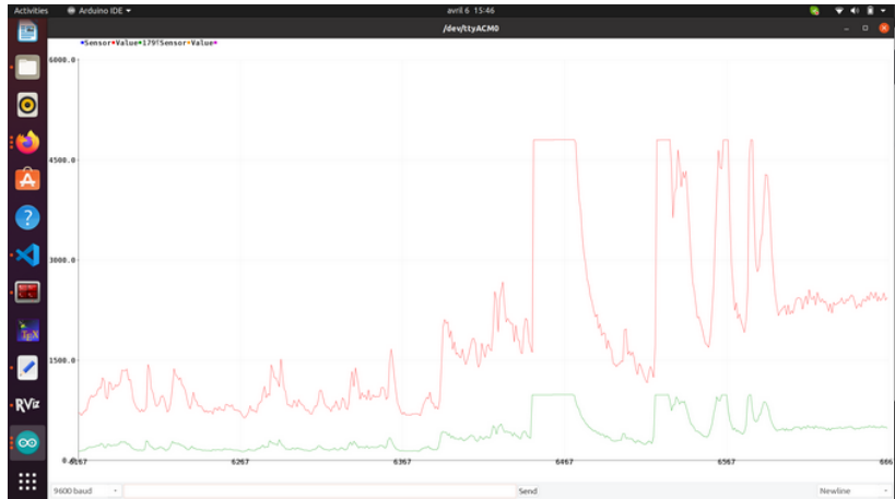
FIGURE II.1.9 – Enveloppe du signal capté, les valeurs en rouge sont les valeurs avant l’application du filtre.
