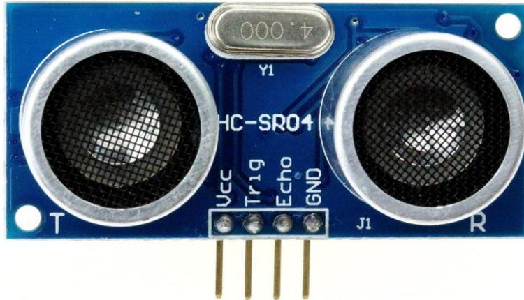
FIGURE II.1.11 – Exemple de capteur ultrason de 5V utilisé pour des projets Arduino
