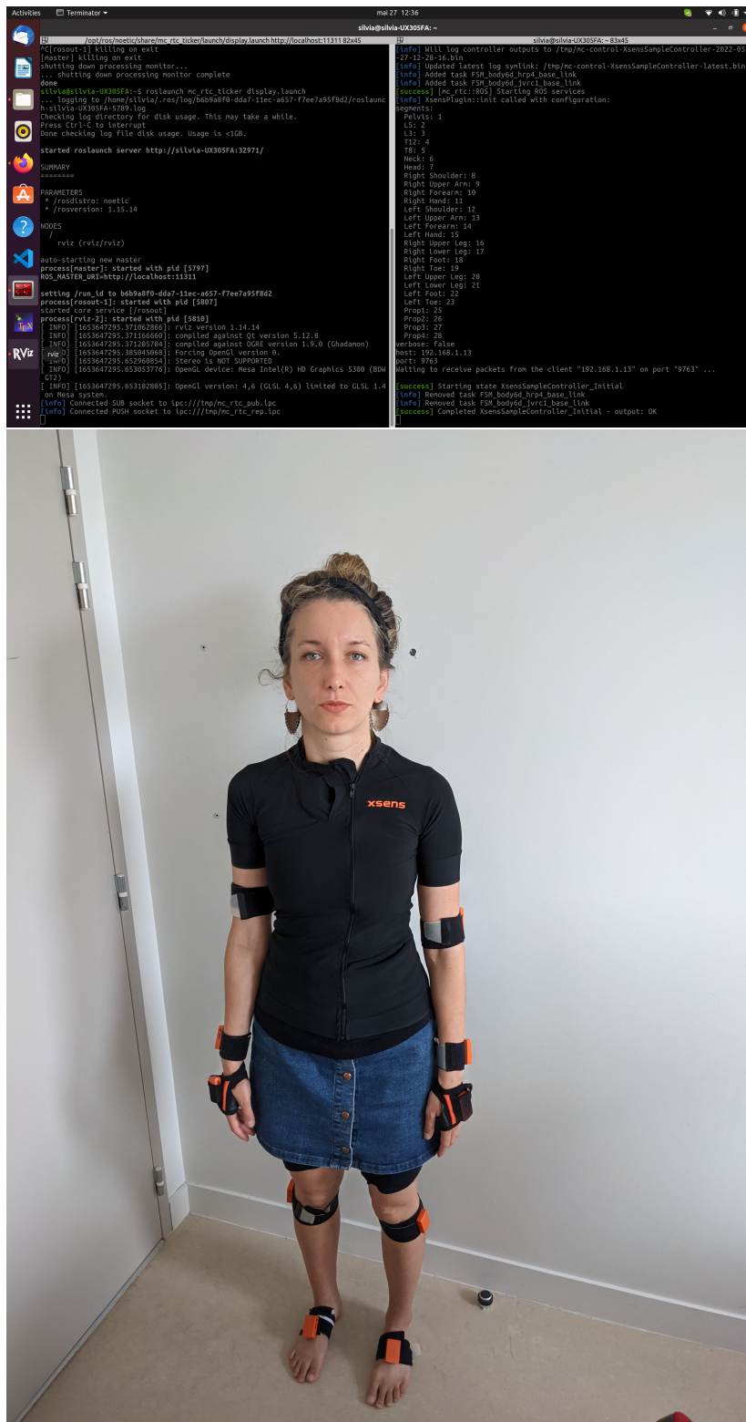
FIGURE III.1.32 – Mise en place d’une démo avec le système MoCap Xsens dans l’interface mcrtc.
