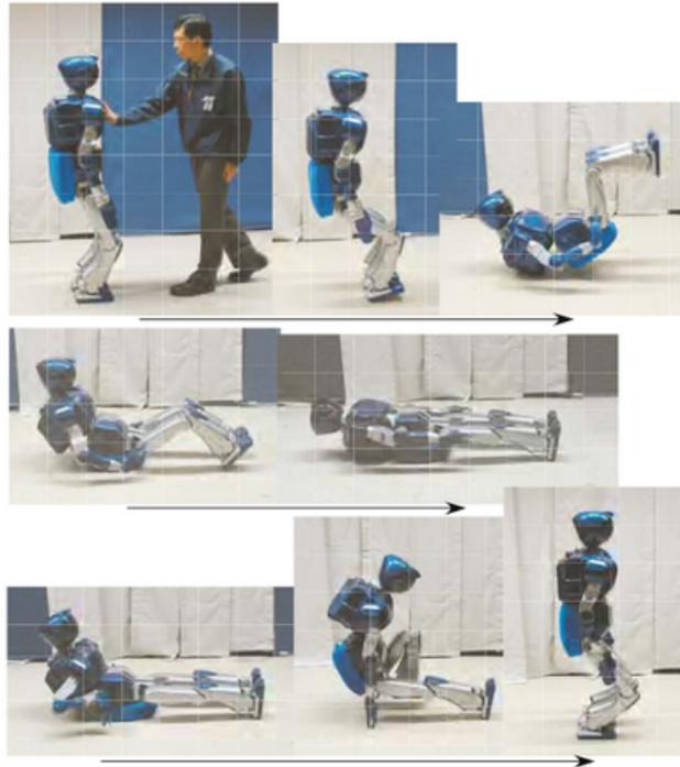
FIGURE II.1.26 – Illustration des mouvements pour se redresser de la chute. Source : le livre[kajita2014springer]
