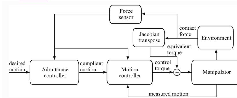
FIGURE II.1.27 – Schema qui illustre le fonctionnement de l’admittance. Source : le livre[natale2020springer]
