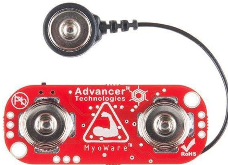
FIGURE II.1.8 – capteur électromyographique de surface
