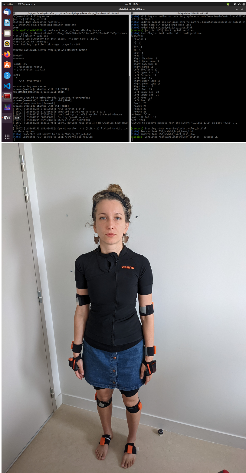
FIGURE II.1.32 – Mise en place d’une démo avec le système MoCap Xsens dans l’interface mrcrtc.
