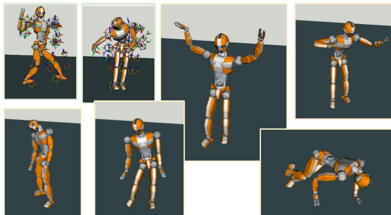
FIGURE II.1.34 – Exemple de postures lors de la simulation avec le costume XSens.
