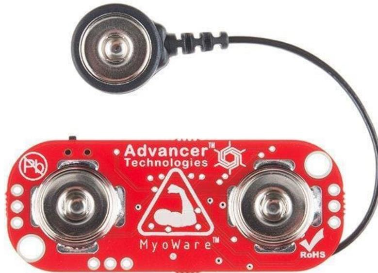
FIGURE II.1.8 – capteur électromyographique de surface
