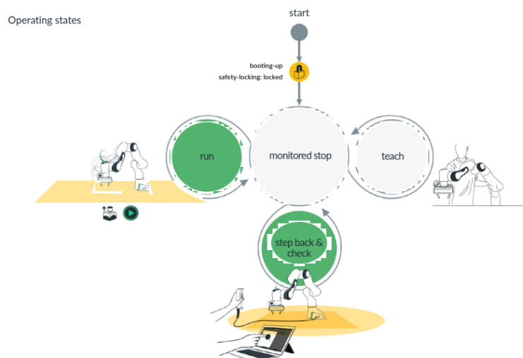
FIGURE II.1.21 – Fonctionnement du mode apprentissage pour le bras robotique Panda. Source : FRANKA EMIKA ROBOT'S INSTRUCTION HANDBOOK
